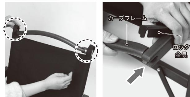
⑥ロック金具に生地がかぶさるように生地を整え、ループ(2本)を本体フレームに引っ掛け固定します。
